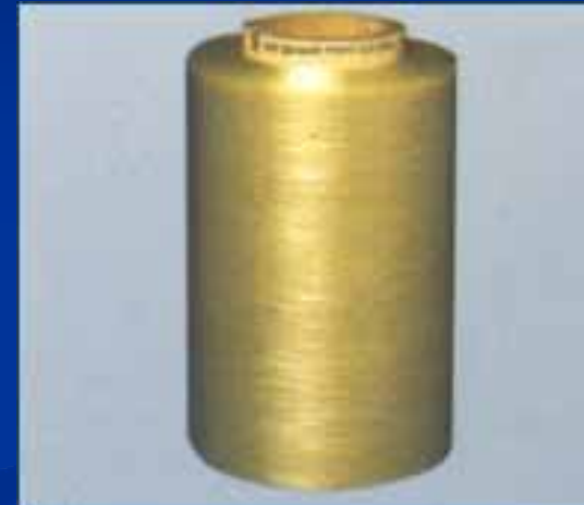
Ровинг прямой (применяется для изготовления изделий из стеклопластика методом намотки)
