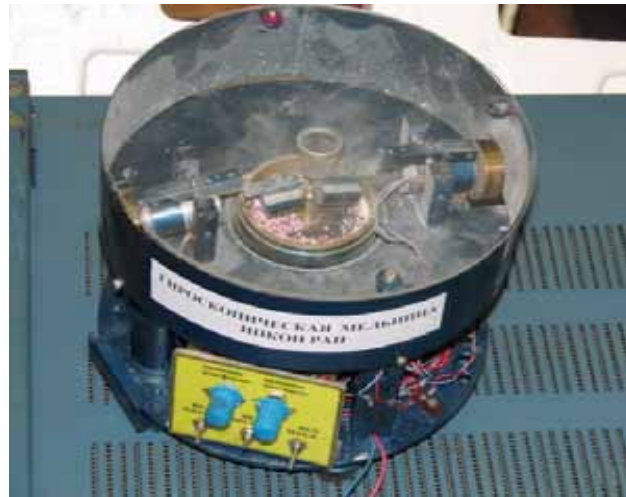
Рис. 2. Внешний вид экспериментального образца гироскопической мельницы ГМ с центральной загрузкой рудного материала
