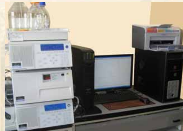
Система ВЭЖХ Series 200 UV/Vis
