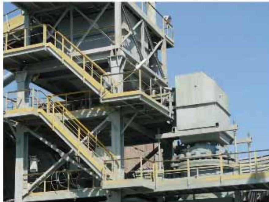
Агрегат для вибрационного дробления материала в слое (КИД-1500) в составе комплекса
