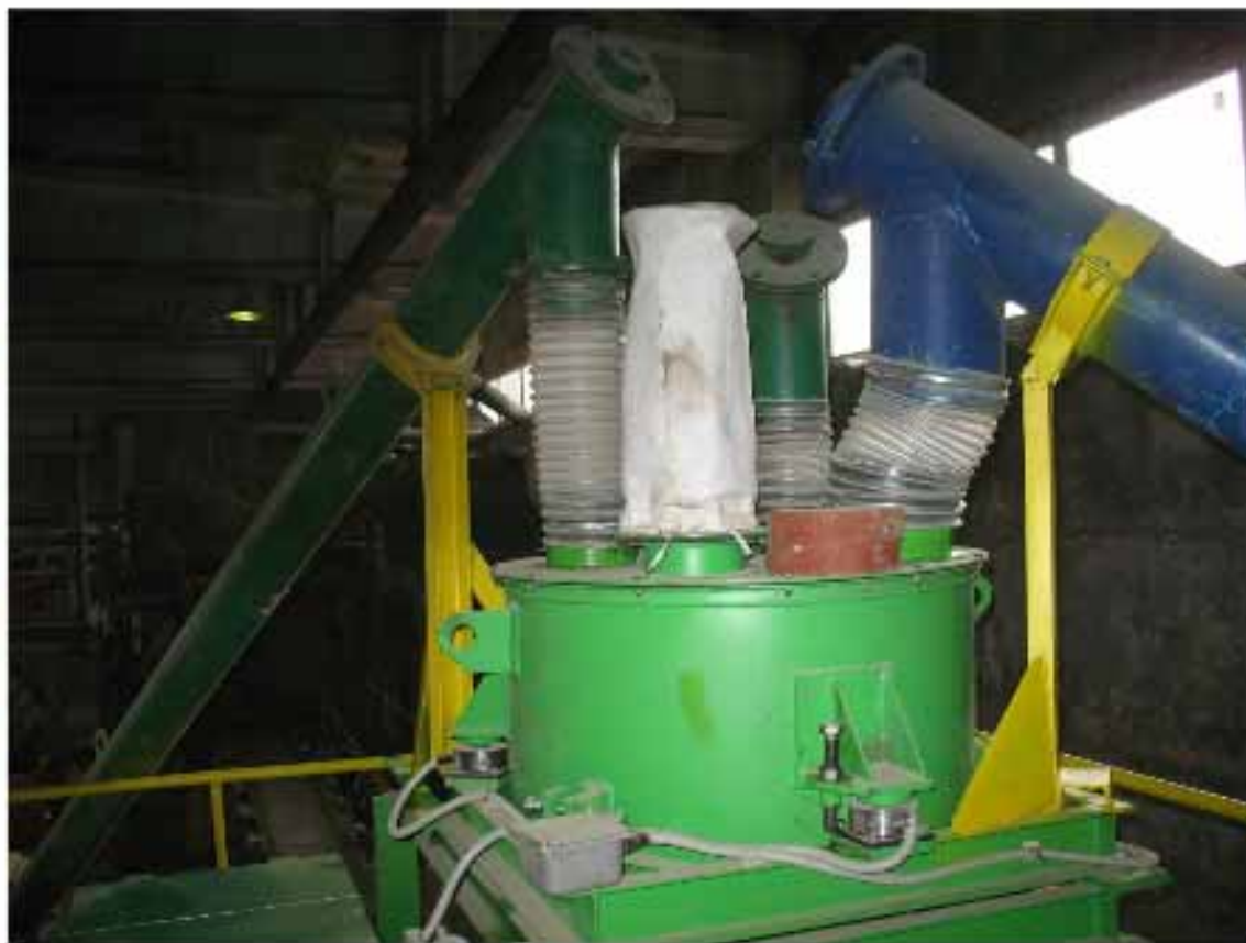
Дозатор компонентов для сухих смесей или вяжущего
