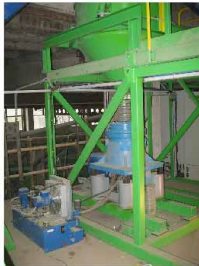
Бункер-накопитель весовой с дробилкой КИД-300 и системой смазки
