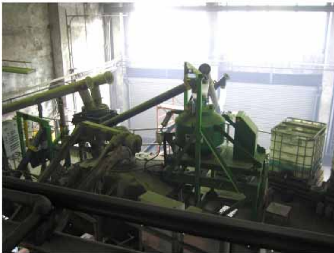
Скоростной турбулентный смеситель и основной бетоносмеситель
