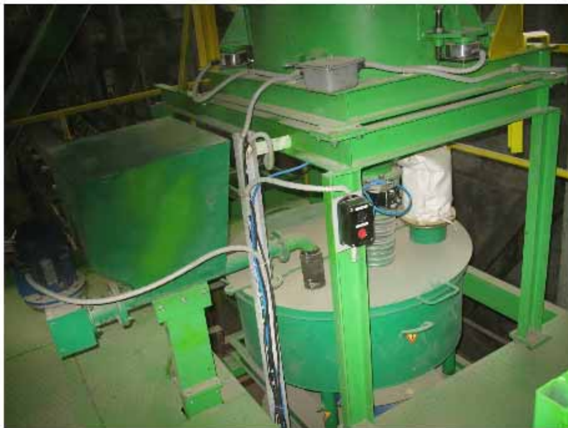
Микродозатор и турбосмеситель «Скаут»
