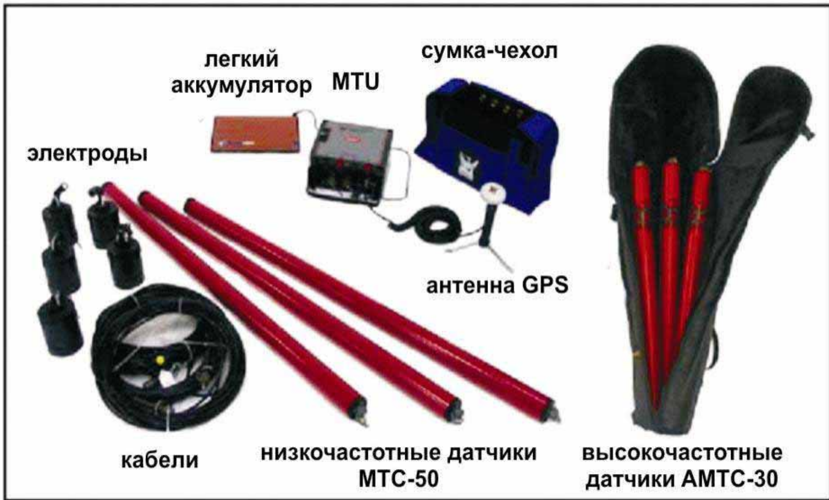
Рис. 5 Первичные приборные блоки регистрации геоэлектрического поля
