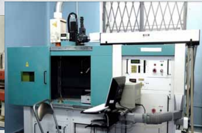
Лазерная установка для герметизации источников
