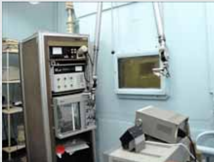
Защитный бокс для работы с высокоактивными источниками
